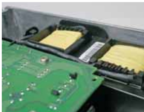
内置直流电抗器，降低谐波，延长变频器使用寿命，并节省客户外置电抗器的空间和成本
