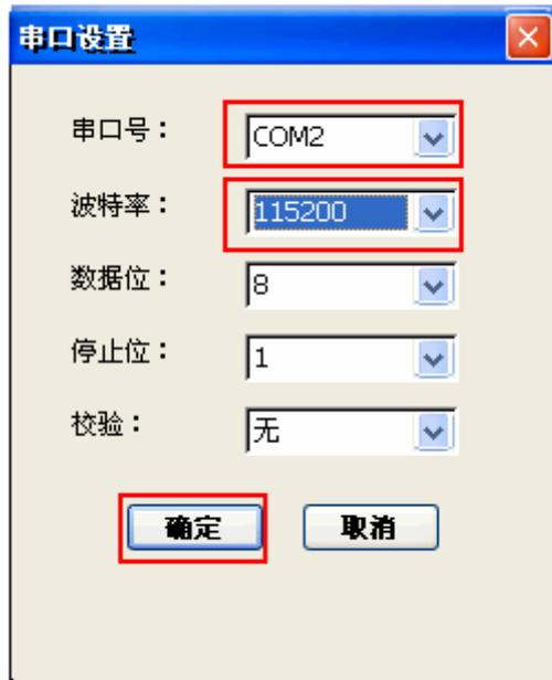
注意：这里应用程序的“COM2”实际对应 UART1，是软件上的端口定义，非开发板硬件接口名称。
