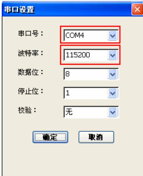
注意：这里应用程序的“COM4”实际对应 **UART3**，是软件上的端口定义，非开发板硬件接口名称。
