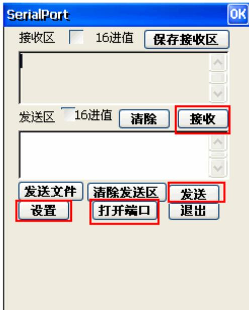
4、点击 SerialPort 界面的“**设置**”键，对串口进行设置，设置完成后，点击“**确定**”。
