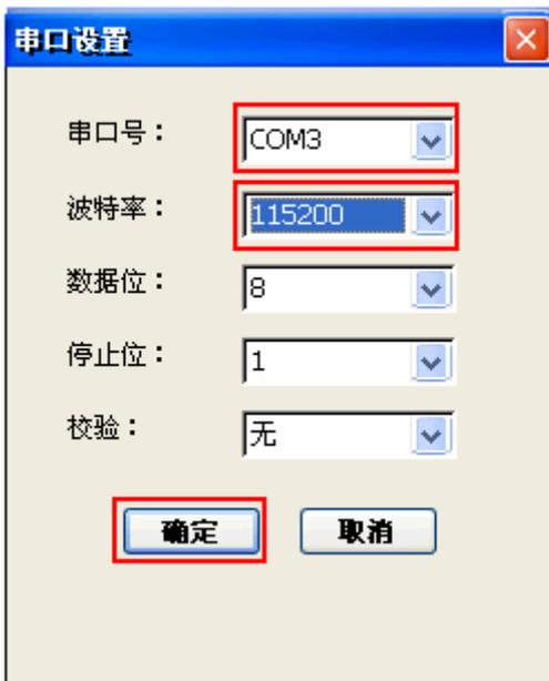
注意：这里应用程序的“**COM3**”实际对应 **UART2**，是软件上的端口定义，非开发板硬件接口名称。
