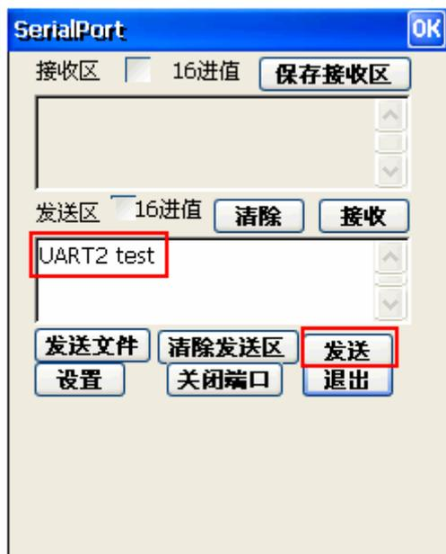
3、PC 端的 **SSCOM32** 将收到开发板发送过来的数据“UART2 test”
