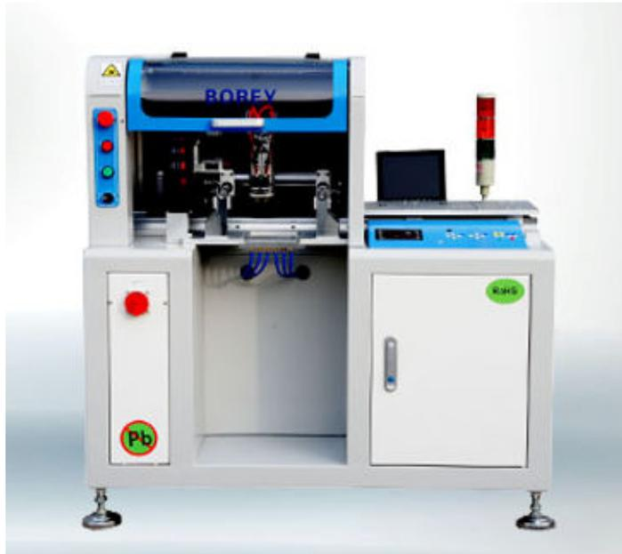
我公司推出国内最可靠 LED 全自动贴片机,专业满足国内电子厂、SMT 加工厂、LED 厂商贴装 0402、0603、0805、1206、1210、LED3528 器件、LED5050 封装器件二级管、三极管等,有效的提高了贴装的精度和效率,节省大量人工成本。产品已在大量投入市场,使用稳定,操作简单,是一款具有高性价比的全自动贴装机。
