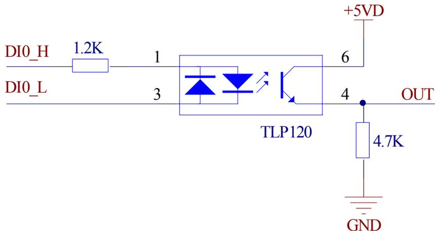
当 DI0\_L 端接地时，DI0\_H 输入高电平，光耦导通，输出信号 OUT 为高电平；DI0\_H 输入低电平，光耦不导通，则 OUT 输出为低电平。当 DI0\_L 接电源正端时，DI0\_H 输入低电平，光耦导通，输出信号 OUT 为高电平；DI0\_H 输入高电平，光耦不导通，则 OUT 输出为低电平。
