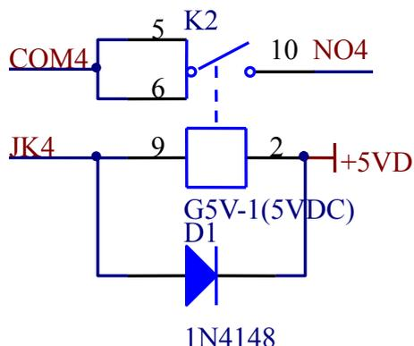
当程序选择继电器 4 开时，继电器 K2 内部开关的 COM4 端吸合到 NO4 端，COM4 与 NO4 端相连；当程序选择继电器 4 关时，K2 的 COM4 与 NO4 端之间断开。
