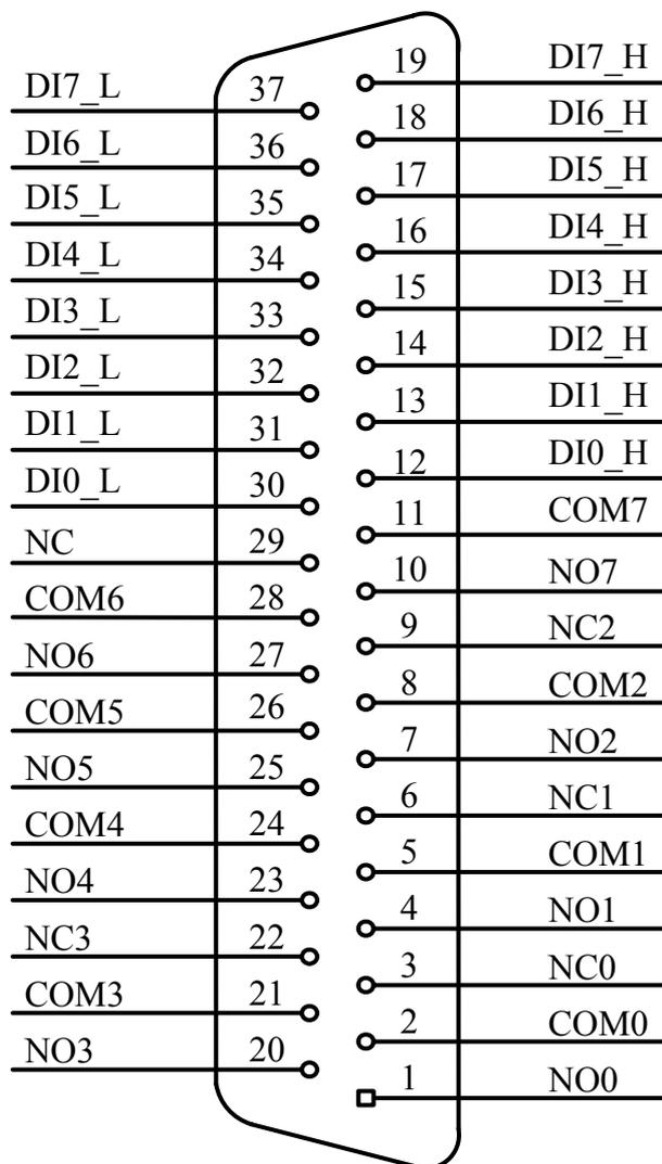
关于 37 芯 SCSI 型插头 CN1 的管脚定义（表格方式）
