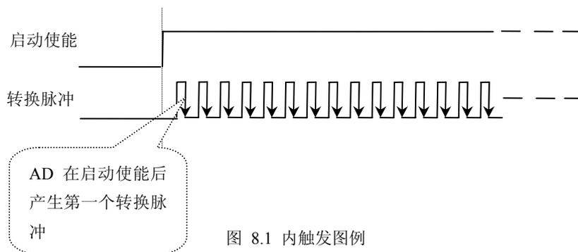
图 8.1 内触发图例
