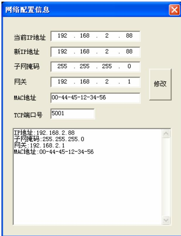
3、若需要修改网络配置信息，则可在对应信息右侧的文本框中填写新的信息，例如将 IP 地址改为 192.168.2.90，然后再点击“修改”按钮，则下方的状态栏会显示“修改参数成功，板卡重新上电才能生效”，如下图所示。则应按此提示，拔下 USB 连接线，使板卡掉电，并将程序界面关闭。
