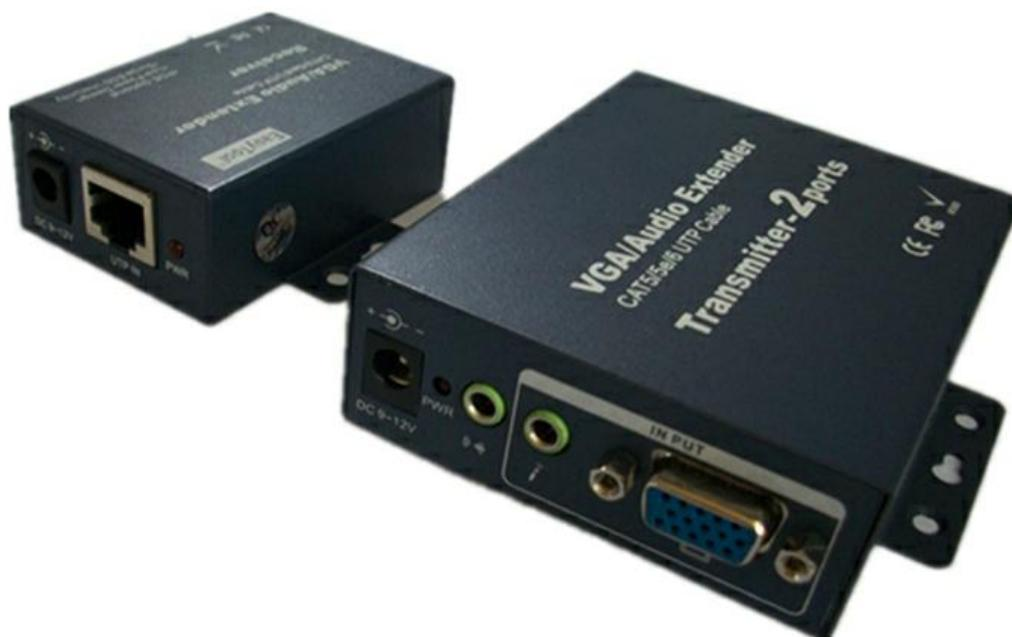
【产品名称】 100米 VGA 双绞线音视频传输器 工程型
