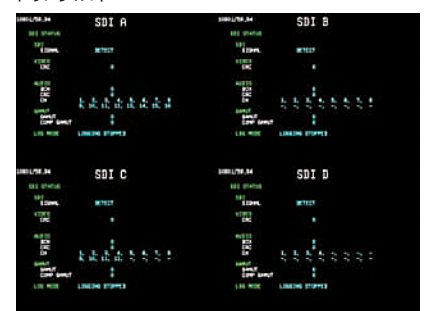
数据状态(LV 5381SER03) 数据状态实时监测。SDI 信号和外同步相位差测量。数据状态错误出现时间, 误码名, 信号记录功能。
