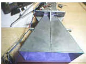
SS-969 微波雷达测速测距传感器
