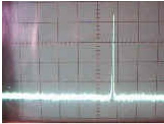
被测移动目标接近探测传感器时的波形 图 28
