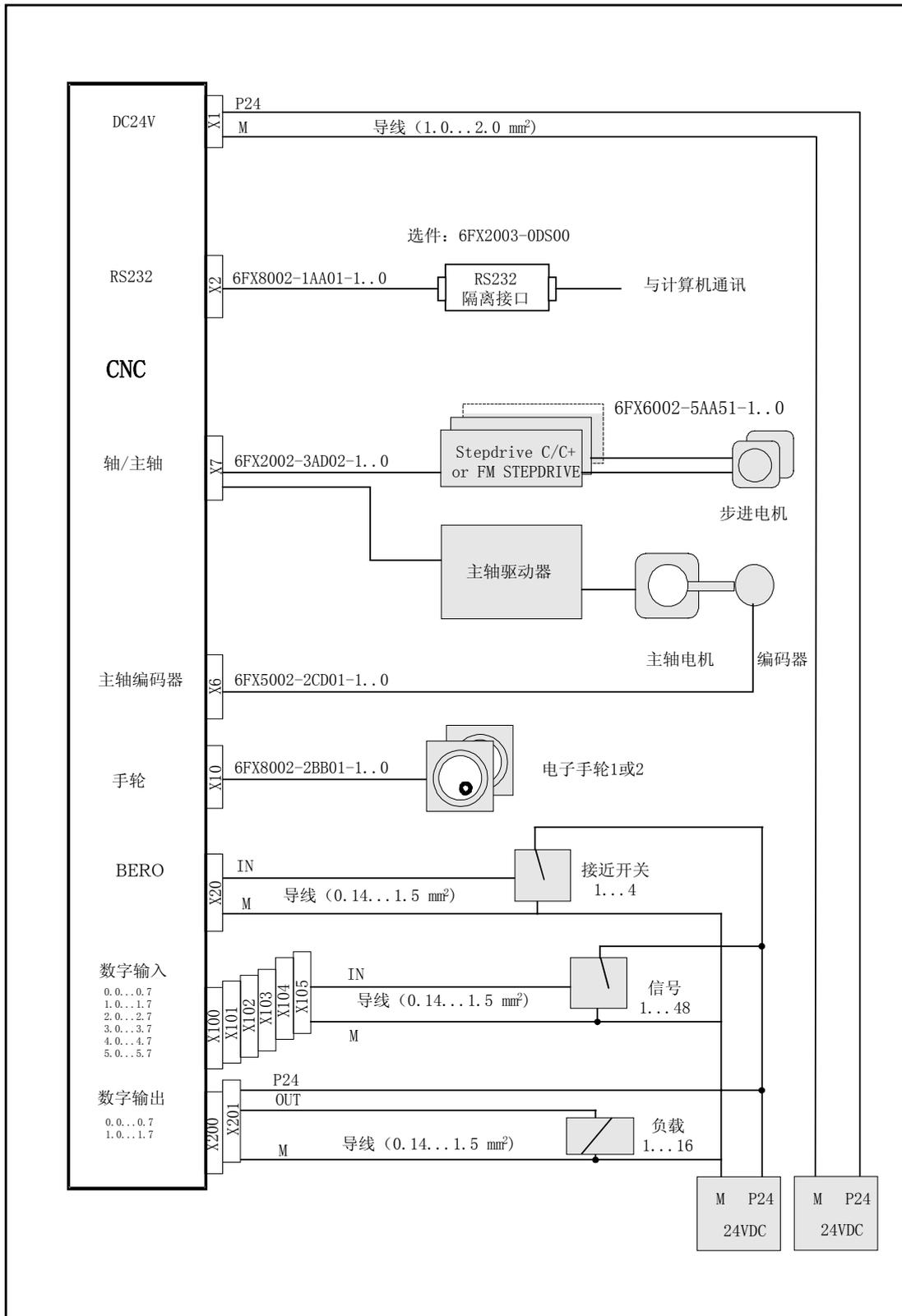
图 2-4 SINUMERIK802S base line 的部件连接
