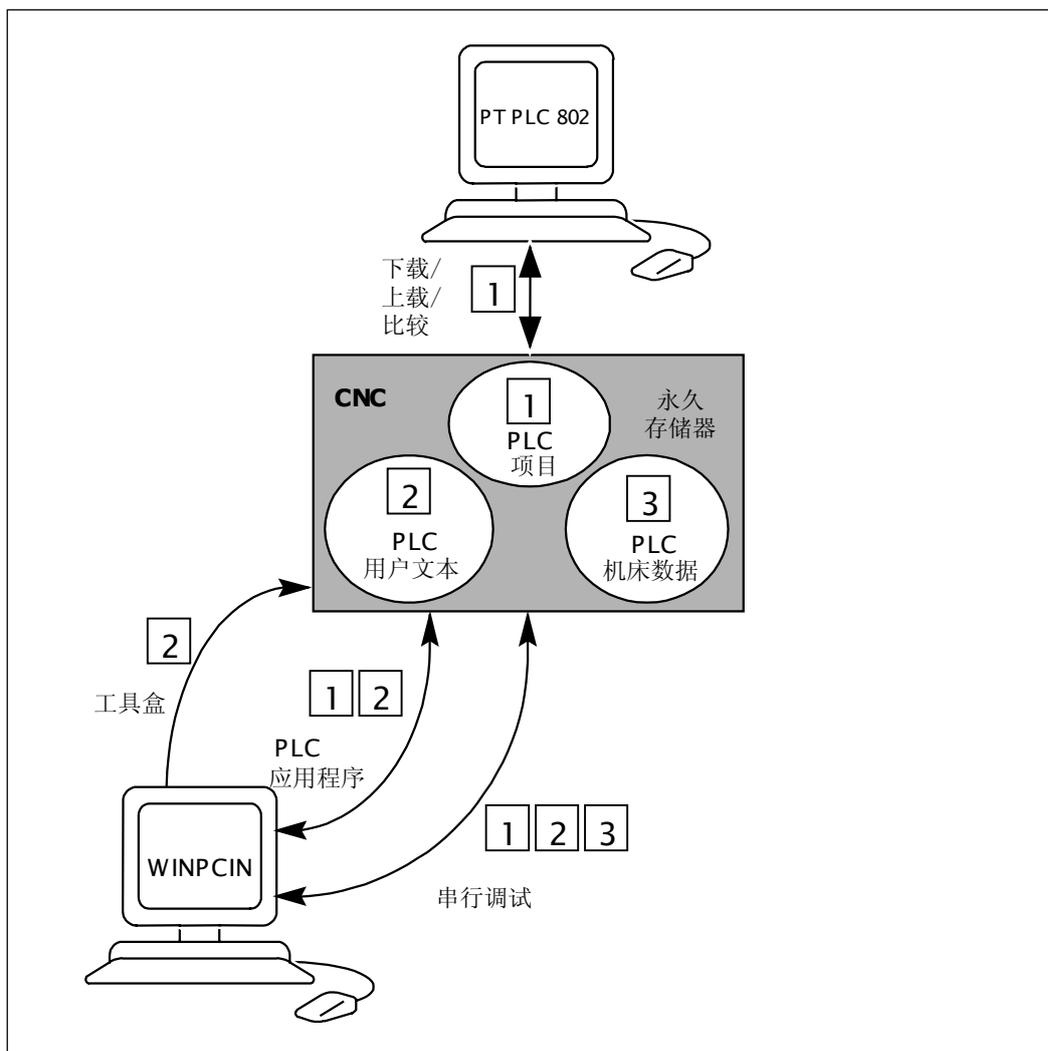
图 4-5 控制系统中的 PLC 用户程序
