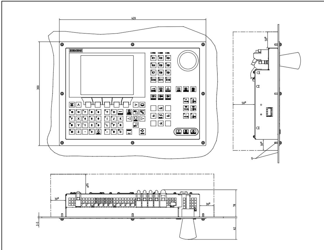
图 2-1 SINUMERIK 802S base line 安装尺寸
