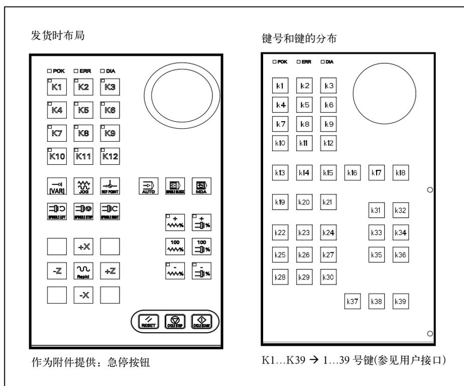
图 4-3 机床控制面板区的布局
