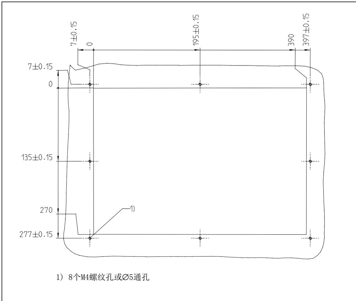
图 2-2 SINUMERIK 802S base line 安装尺寸
