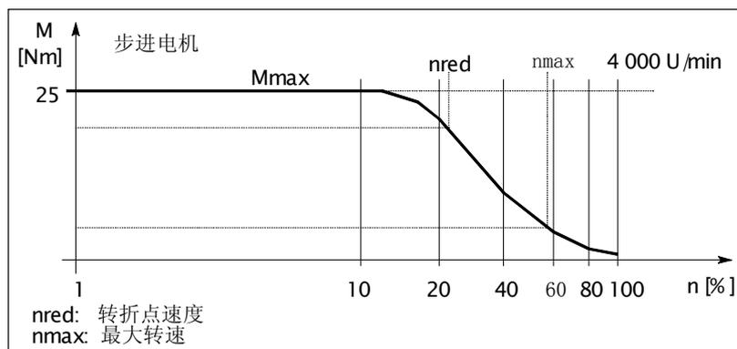
图 4-6 步进驱动电机特性曲线
