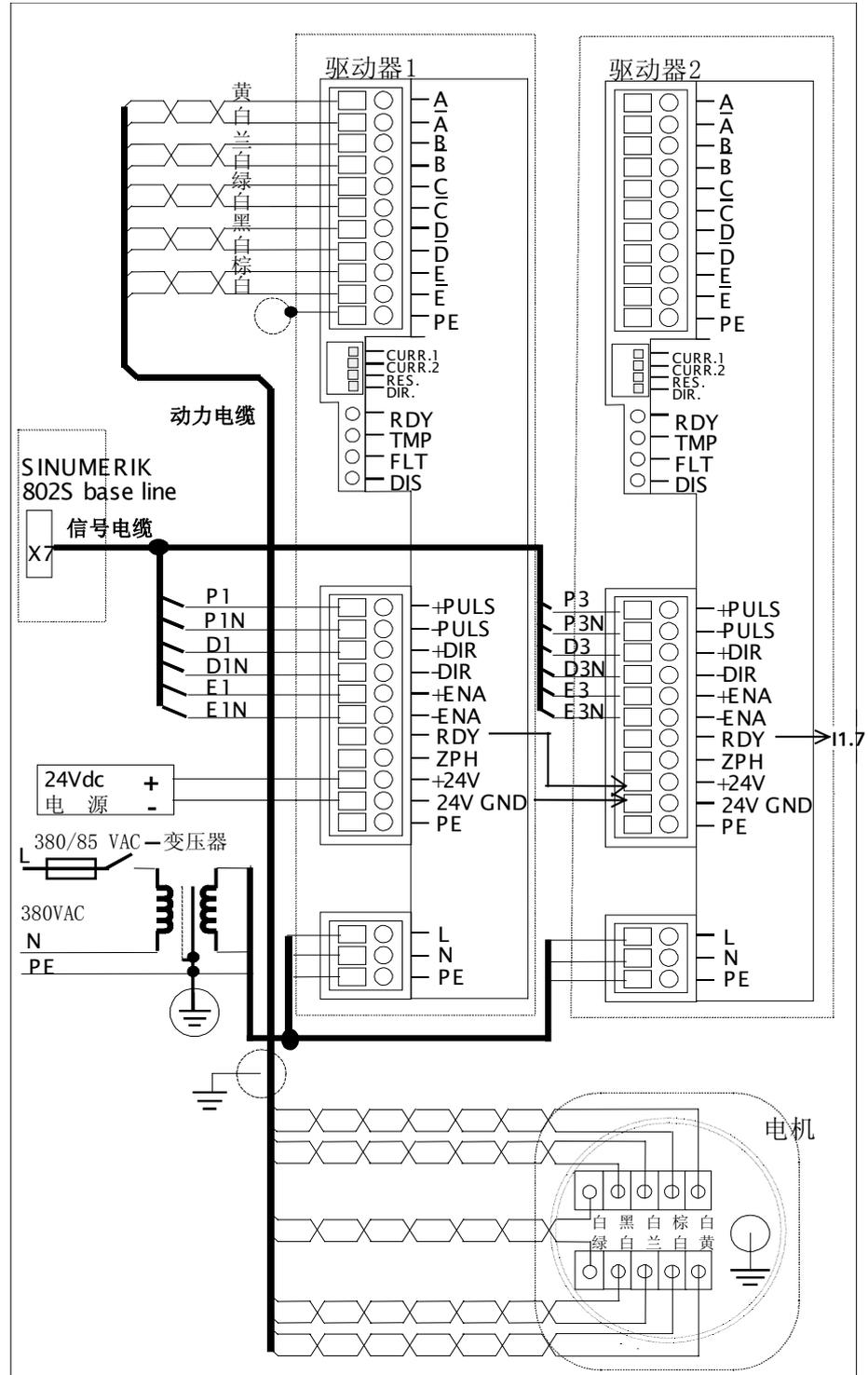
图 3-2 电缆连接图
