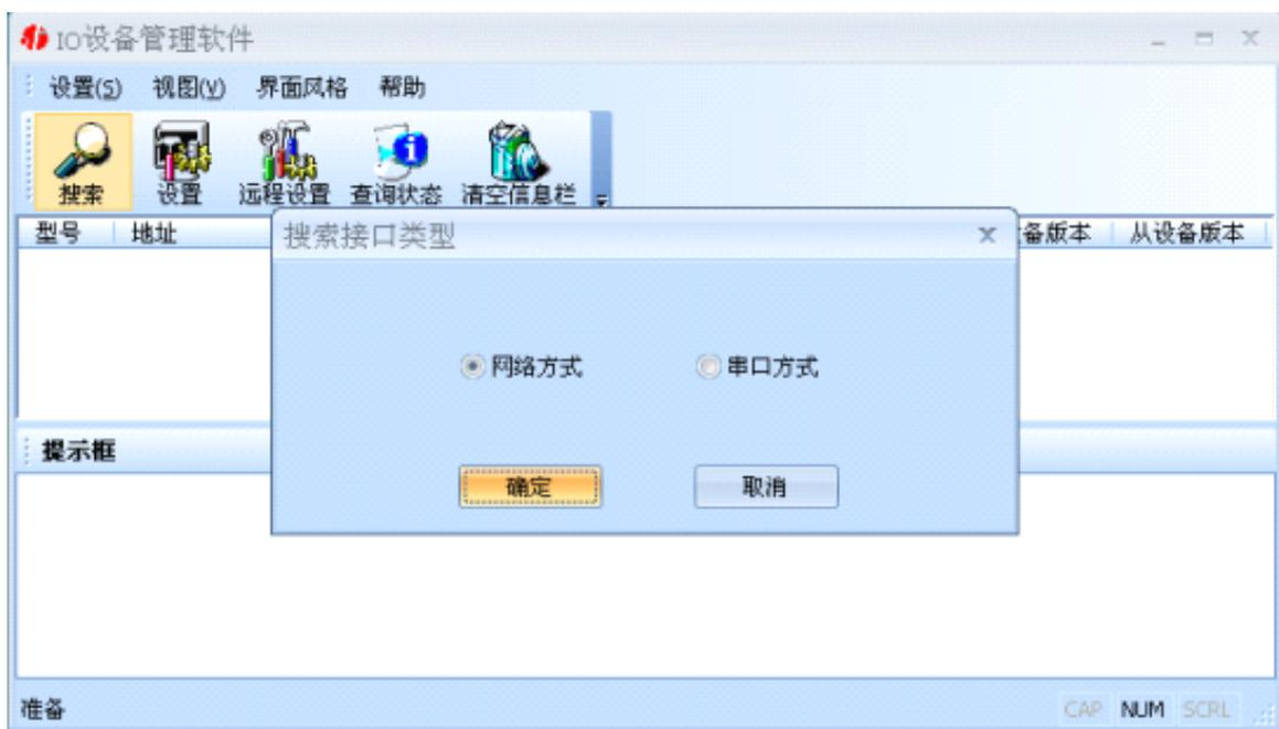
选择合适的通信方式，比如我们现在要用的网络方式。选择好相应的方式后，点击确定，设置程序就会找到我们联系本地局域网中的M281-4。如下图：
