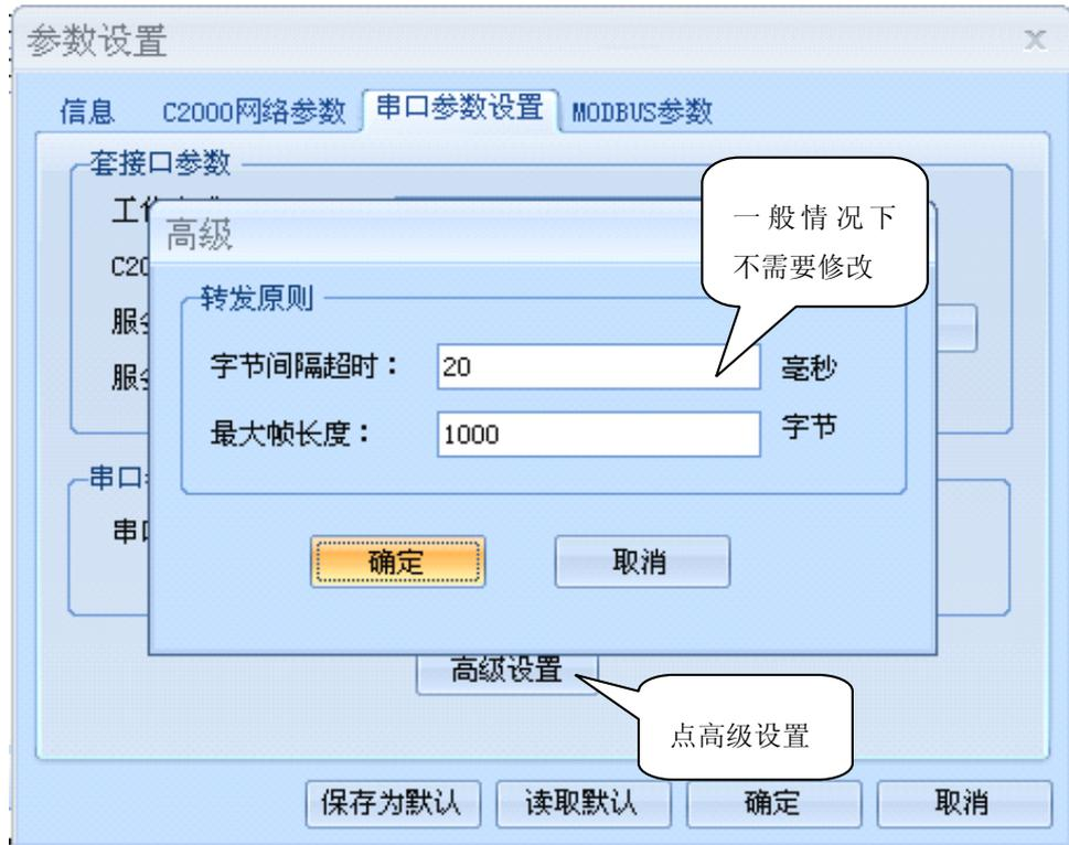
**字节间隔超时：** C2000 从串口收到字节后，在“字节间隔超时”过后，还没有从串口收到下一个字节，C2000 将收到的数据发送到网络上，推荐修改范围为 0~100ms。
