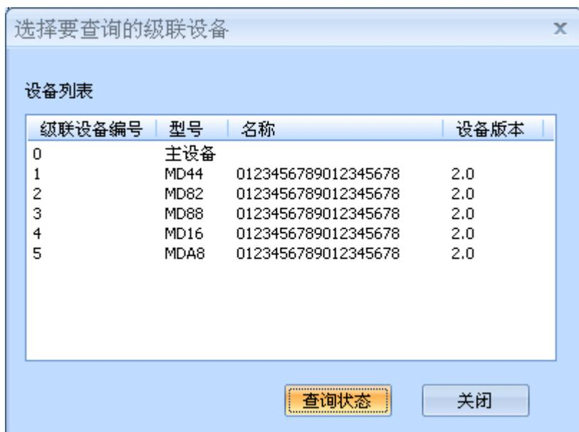
可以通过双击列表中的设备或选中列表中的设备点击“查询状态”按钮来对IO的状态进行查询。不管是主设备还是级联设备，都可以通过这种方式进行查询。如下图：
