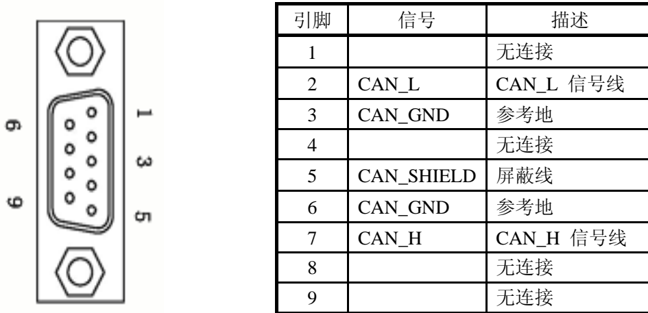
图 2-2 CAN 接口端子定义
