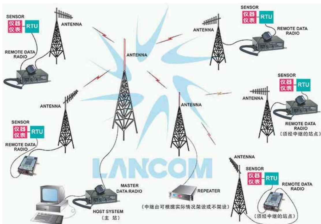
远程监控系统的基本构成示意图
