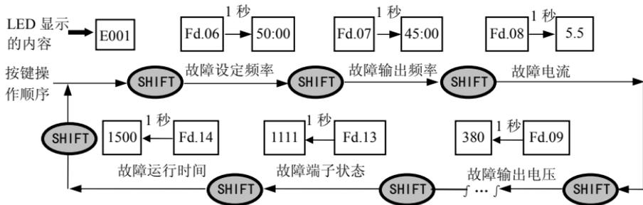
图 4-11 故障状态查询操作示例
