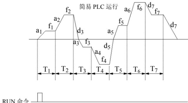
图 6-22 PLC 单循环后停机方式
