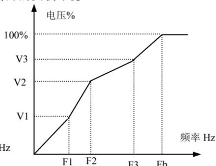
V1~V3: 多段 VF 第 1~3 段电压百分比
