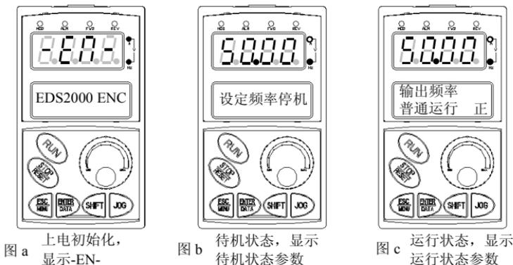
图 4-3 变频器初始化、待机、运行状态时的显示
