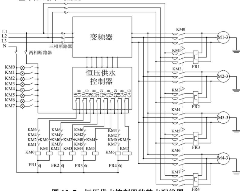
图 10-7 恒压供水控制器的基本配线图
