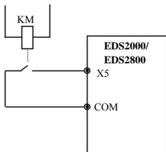
图 6-28 外部设备故障常开输入示意图
