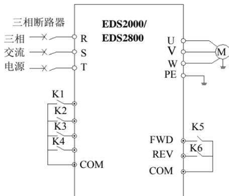
图 6-27 多段速运行接线图
