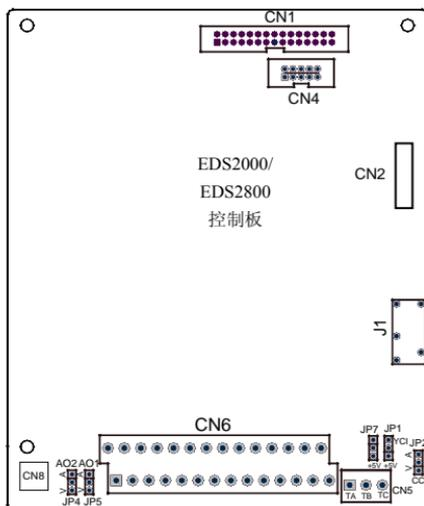
图 3-10 控制板的跳线开关位置示意图
