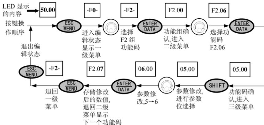
图 4-7 参数设置与修改的操作示例
