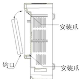
图 3-3 操作键盘的安装示意
