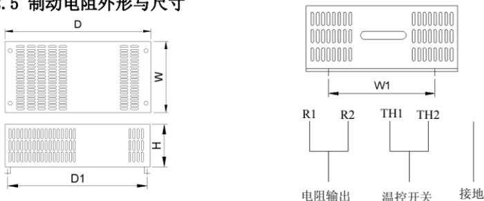
图 9-6 制动电阻外形与尺寸示意图
