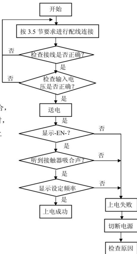
图 4-12 变频器初次上电操作流程
