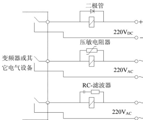
图 3-22 电磁开闭类电器的安装要求
