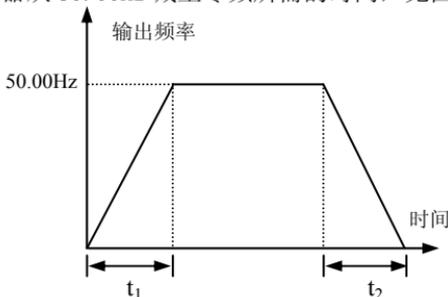
图 6-3 加减速时间定义
