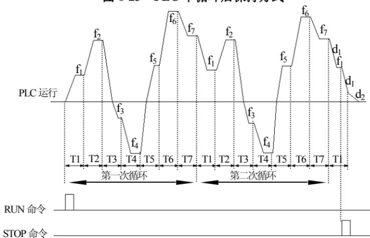
图 6-24 PLC 连续循环方式
