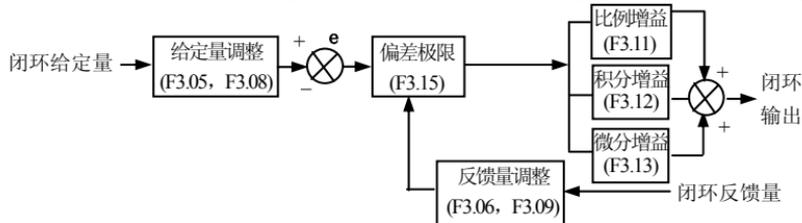
图 6-16 PID 控制原理框图
