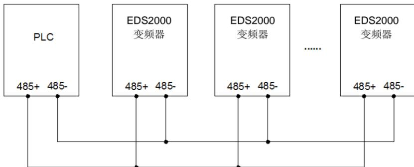
图 3-18 PLC 与变频器多机通信时推荐的接线图
