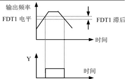
图 6-35 频率水平检测示意图
