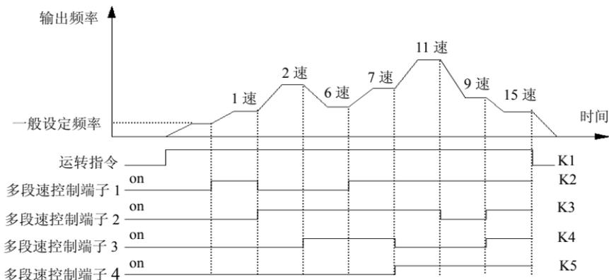
图 6-26 多段速运行示意图
