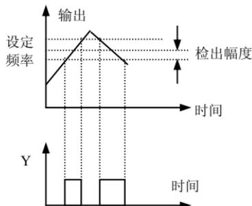
图 6-34 频率到达信号输出示意图
