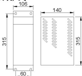
图 9-5 制动单元的安装尺寸示意图
