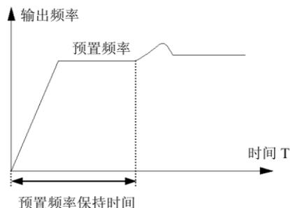
图 6-20 闭环预置频率运行示意图
