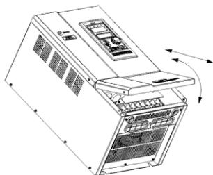
图 3-5 钣金盖板的拆卸和安装示意图
