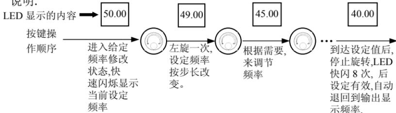
图 4-8 设定频率调整操作示例
