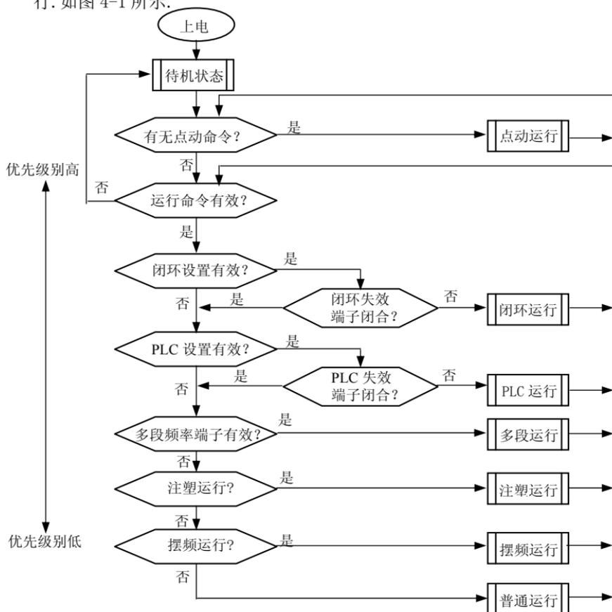
图 4-1 EDS2000/EDS2800 变频器运行状态的逻辑程序
