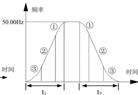
图 6-2 S 曲线加减速
