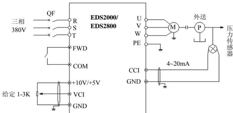
图 6-15 内置 PID 模拟反馈控制系统示意图
