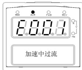
图 4-4 故障告警显示状态
