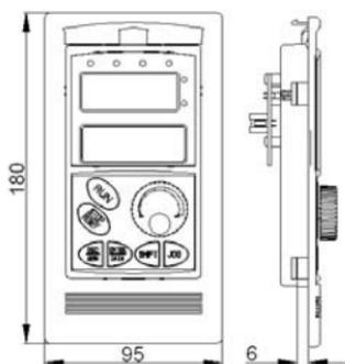
图 a EN-KB1 键盘安装外形尺寸
