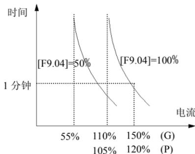
图 6-42 电子热继电器保护
