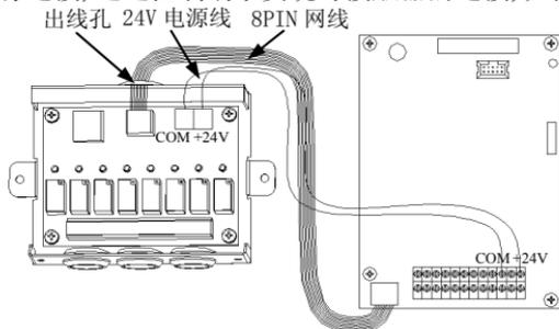
图 10-8 恒压供水控制器与变频器的连接(外置)
