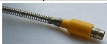
半硬电缆加弹簧外套 可以在传感器上直接接电缆
