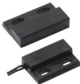
GPS-23 是我公司生产的常开型磁控开关，是一款通用接近式磁性开关。该开关可以用电磁控制，也可用永磁铁控制，或是两者的结合。实现无接触控制。开关的线材、接线端子、引线的长度开关功率及控制距离均可应客户要求定做。
