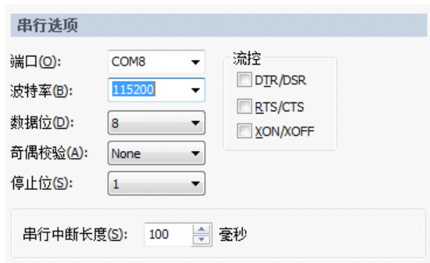
Figure 31. USR-WIFI232-G 缺省 UART 参数
