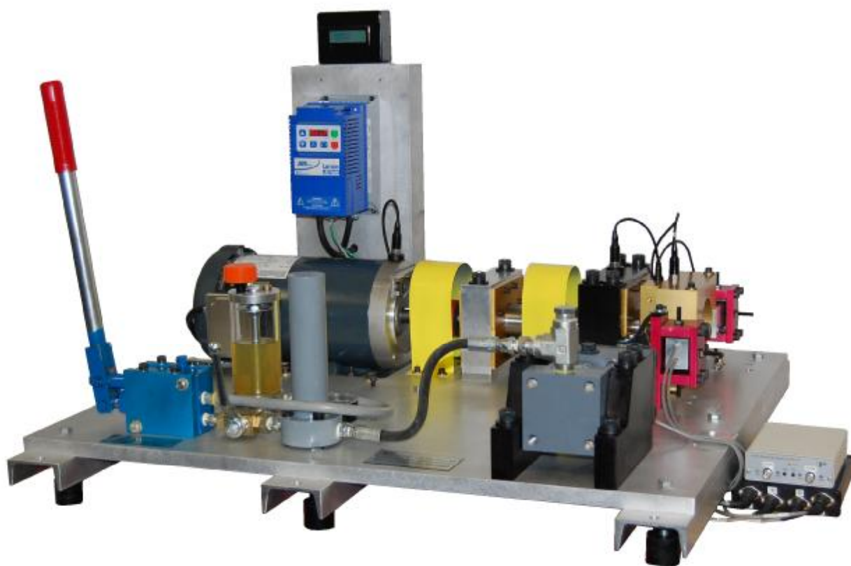
新型轴承故障预测研究实验台
