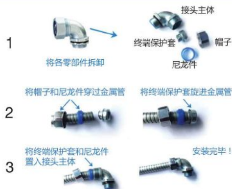
双锁紧金属 电缆防水接头
