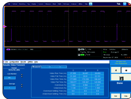
► RGB 瞬态响应测量结果 (选件 VGA)。
