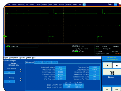
► 行同步测量结果 (选项 VGA)。
