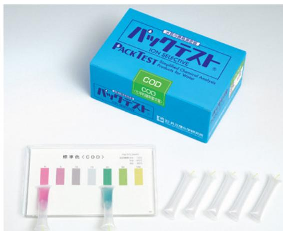
水质简易测定器使用安全、简单且广泛的使用在废水管理、环境污染等调查研究。透过测试包表面所显示的颜色，便能量度出污水中金属或化学品的浓度，可广泛地使用在污水测试、饮用水测试、研究环境污染等多方面，使用方法非常简单而且非常安全，快速准确任何人都会使用。
