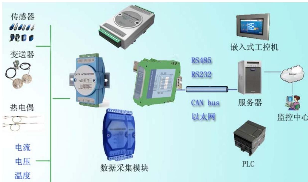
图 1.1 基于 DAM 模块的分布式数据采集系统
