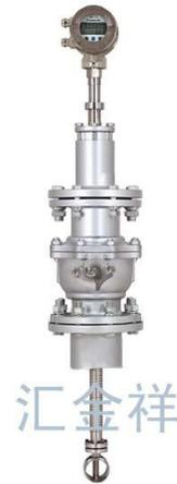
涡街流量计是利用流体卡门旋涡原理开发的一种流量计，该流量计无可动部件，性能可靠、精度高、寿命长，可在很宽的流量范围内精确测量液体的瞬时流量和累计流量。且流量计在测量过程中不受介质温度、压力及组份的影响；同时不易堵塞、不易结垢、耐高温、高压，安全防爆。适用于测量过热蒸汽、饱和蒸汽、压缩空气及一般气体、液体的体积流量。
