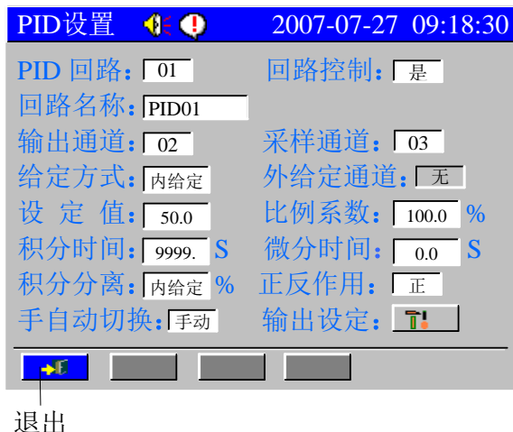
图 5.12 PID 通道参数设置画面
