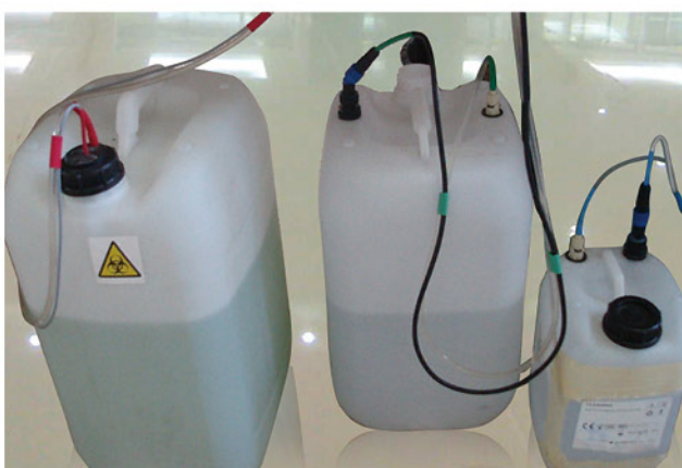
高灵敏液位传感系统： 含系统液传感系统、清洗液传感系统、废液传感及收集系统
