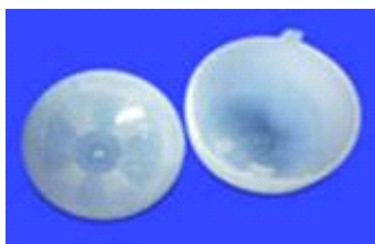
型号: NL-02 焦距: 10.05mm 角度: 100° 距离: 10m 尺寸: 直径 23.5mm 高 12.3mm
