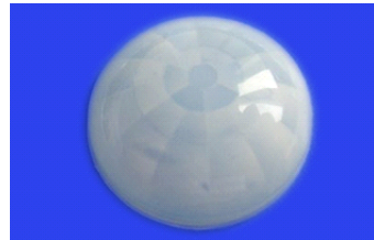
型号: 2814 焦距: 15mm 角度: 140° 距离: 6m 尺寸: 直径 28mm
