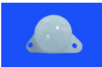
型号: 2135-1 焦距: 7.5mm 角度: 120° 距离: 5m 尺寸: 外径 15mm 内径 14mm
