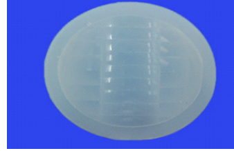
型号: 0512H 焦距: 31mm 角度: 垂直 120° 水平 60° 距离: 12m 尺寸: 60mm×52mm
