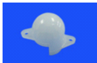
型号: 2134-1 焦距: 7.5mm 角度: 120° 距离: 5m 尺寸: 外径 15mm 内径 14mm
