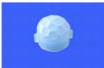
型号: 8006 焦距: 4mm 角度: 100° 距离: 5m 尺寸: 直径 9.35mm 高 7.16mm
