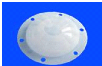
型号: 8605-2 焦距: 15mm 角度: 360° 距离: 5m 尺寸: 直径 44.5mm
