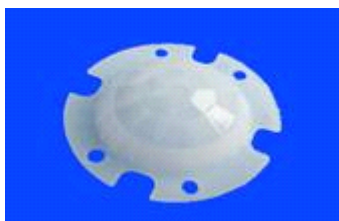
型号: 8603-3 焦距: 17.5mm 角度: 360° 距离: 5m 尺寸: 直径 45.9mm
