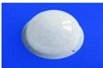
型号: 001 焦距: 21mm 角度: 120° 距离: 10m 尺寸: 外径 55mm 内径 44mm
