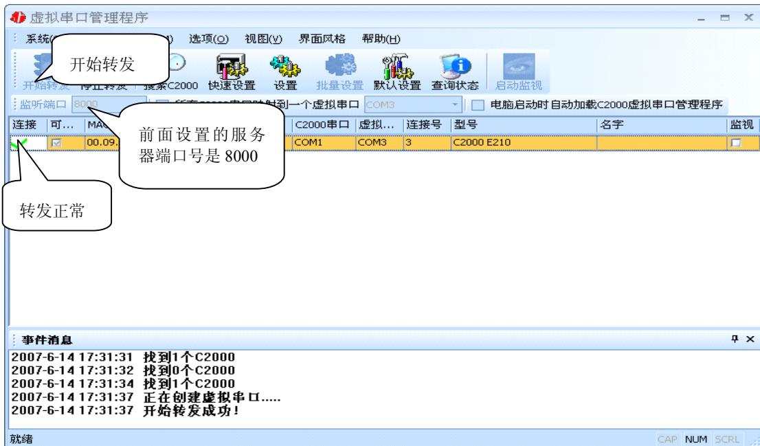
监听端口只有与服务器端口（在串口参数设置里面）匹配了才能正常转发，否则会失败。至此 TCP Client 模式下的转发已经完成，开启用户软件，选择相应的串口就可以进行通讯了。
