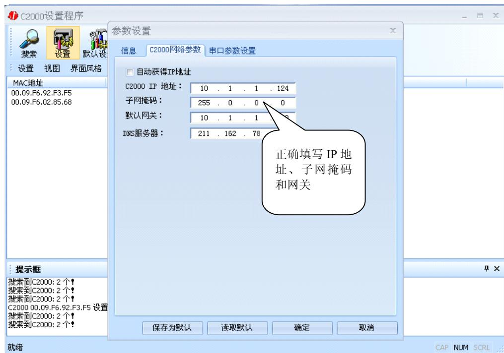
在“C2000 网络参数”栏，可以使用“自动获得 IP 地址”，也可以对其指定 IP 地址、子网掩码和 DNS 服务器，网关即为 C2000 所在网络的网关的 IP 地址。
