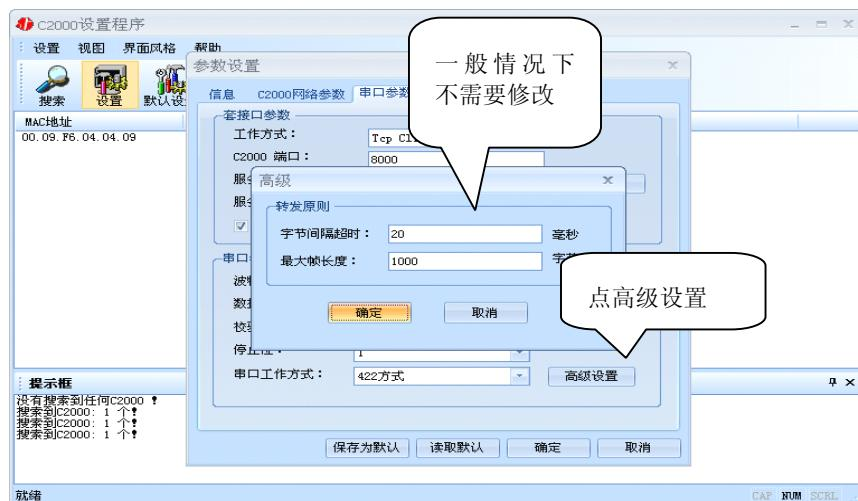
**字节间隔超时：**C2000 从串口收到字节后，在“字节间隔超时”过后，还没有从串口收到下一个字节，C2000 将收到的数据发送到网络上，推荐修改范围为 0~100ms。
