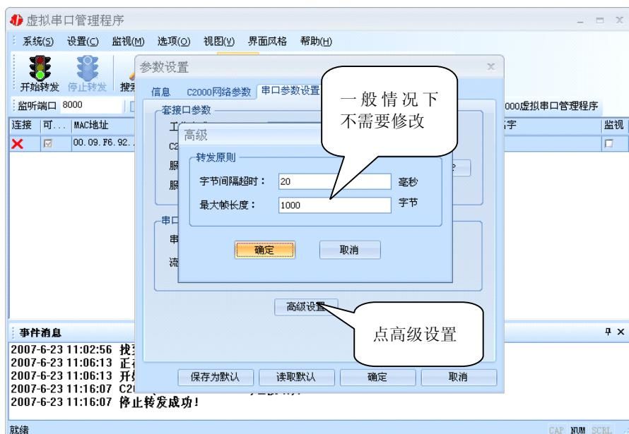
**字节间隔超时：**C2000 从串口收到字节后，在“字节间隔超时”过后，还没有从串口收到下一个字节，C2000 将收到的数据发送到网络上，推荐修改范围为 0~100ms。
