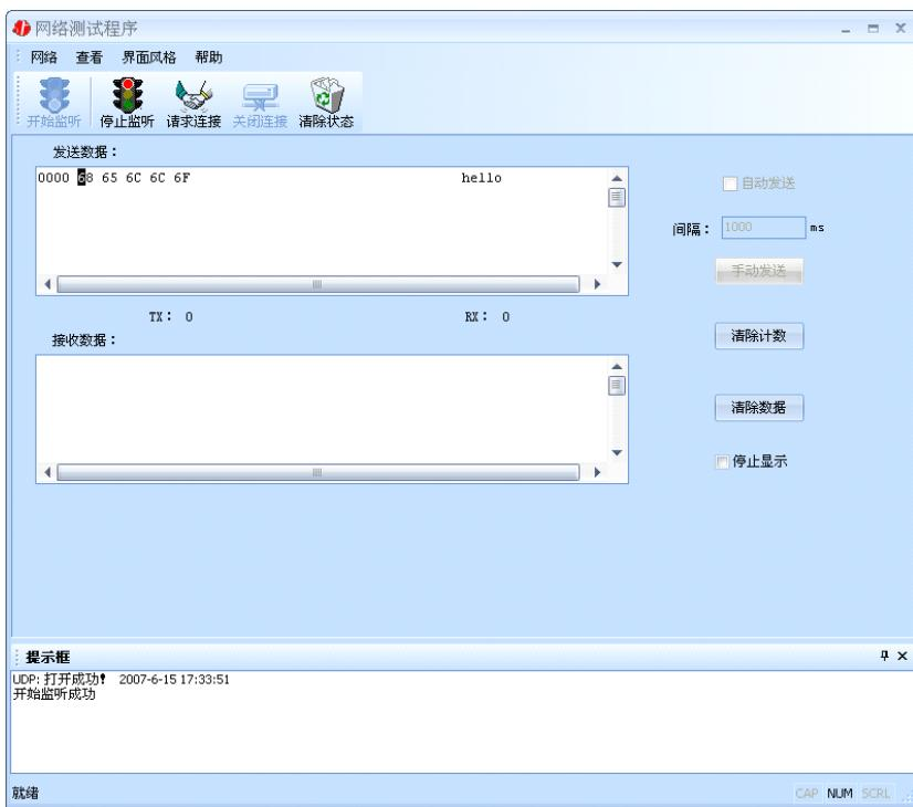
② 如果需要发送数据则需要建立连接。执行“请求连接”：弹出“对方 IP 及端口”窗口，设置要连接对方的 IP 及端口。如下图：
