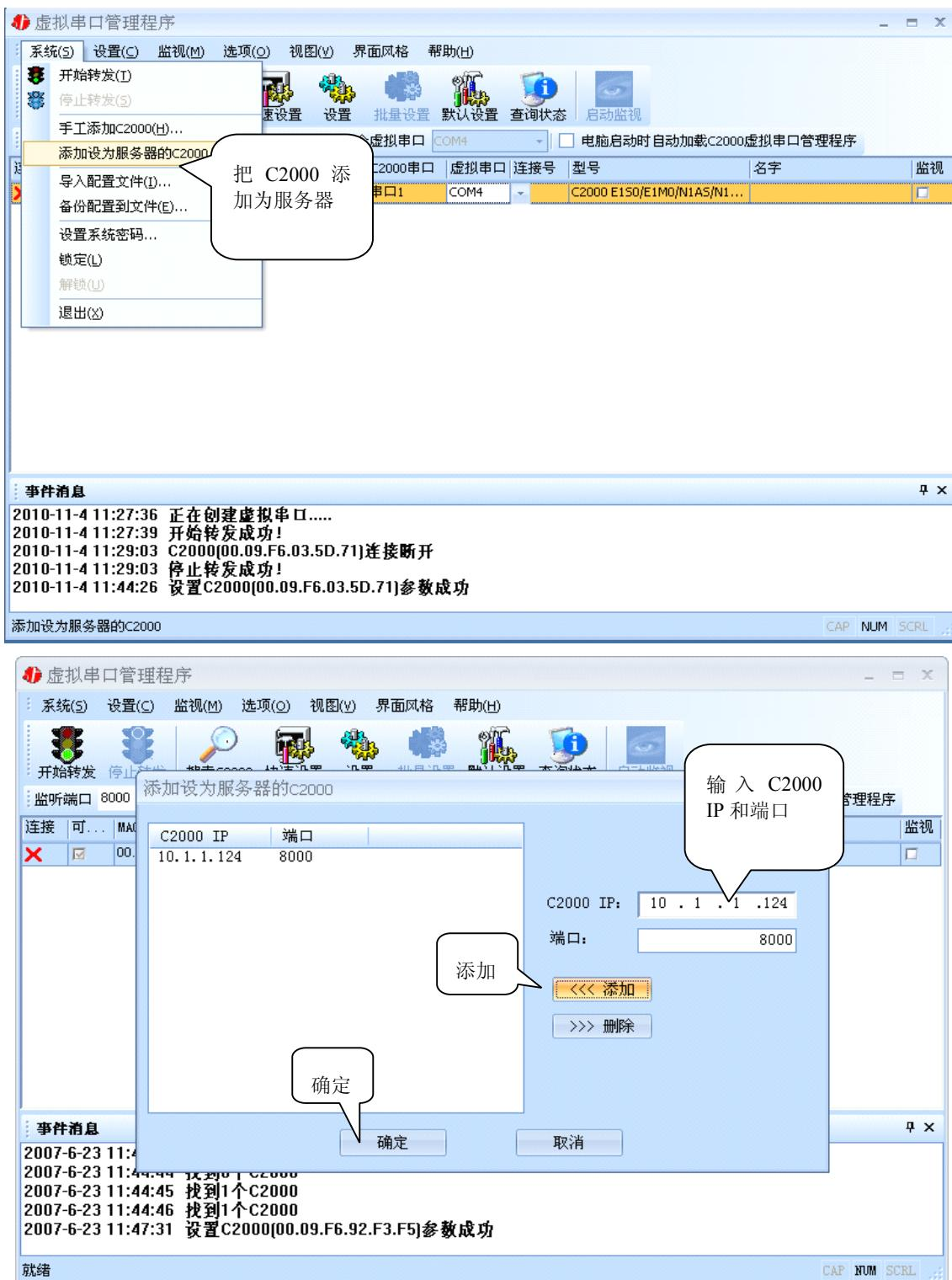
通过上面的操作对 C2000 设置好了参数，那么就需要选择一个或多个虚拟串口来通讯。这样用户基于串口通讯的软件就无需修改即可使用。它有两种选择方式：
