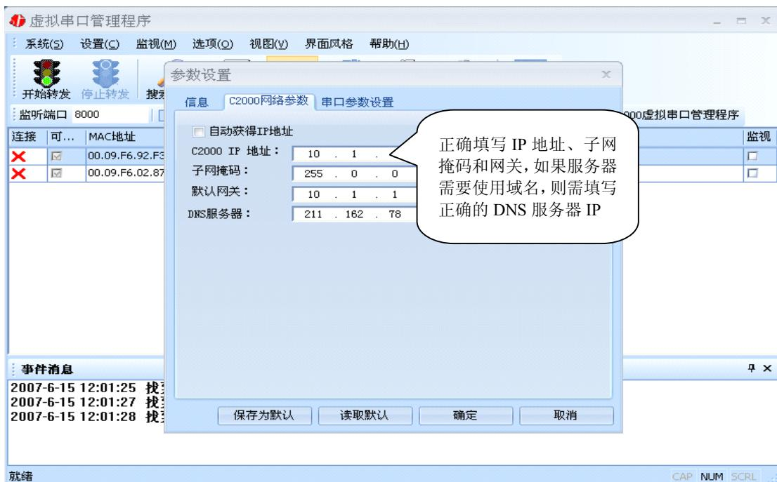
若选择“自动获得 IP”，C2000 所在网段当中的 DHCP 服务器将会为其自动分配 IP 地址和掩码；否则，需要为其指定 IP 地址和掩码。网关即为 C2000 所在网络的网关的 IP 地址。
