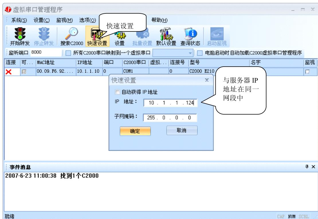
点确定后，C2000 被设为“**TCP Client**”工作模式，服务器 IP 为本机 IP，端口号
