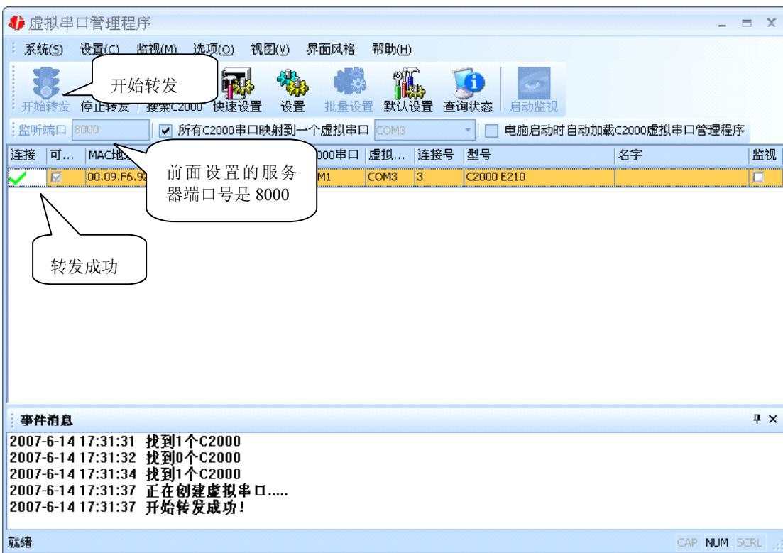
到此 TCP Server 模式的转发已经完成，开启用户软件，选择相应的串口就可以进行通讯了。
