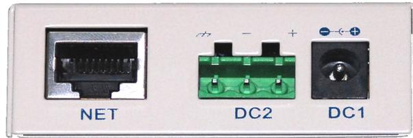
**NET:** RJ45 网络接口，使用时该接口通过网络线将转换器接入 TCP/IP 网络。
