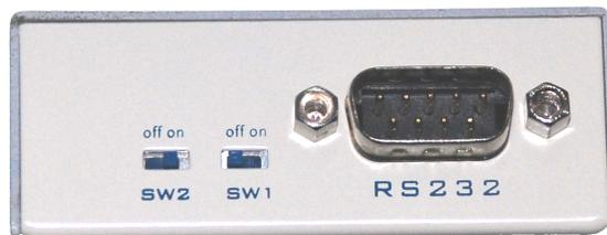
**SW1:** 通过将 SW1 拨到 ON，可以强制转换器使用默认网络设置进行工作，此时转换器的 IP 地址默认为 10.1.1.10，设置密码失效，同时转换器工作在 TCP 客户端方式，并向数据服务器 10.1.1.1 的 8000 端口请求建立 TCP 连接。设置完成后，一定要把 SW1 拨到 OFF 设置才能生效，此时，转换器进入工作状态。
