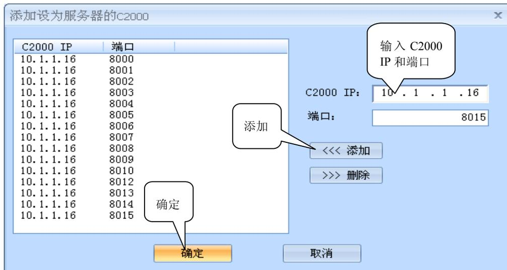
通过上面的操作对 C2000 设置好了转发参数，那么就需要选择一个或多个虚拟串口来通讯。这样用户基于串口通讯的软件就无需修改即可使用。它有两种选择方式：
