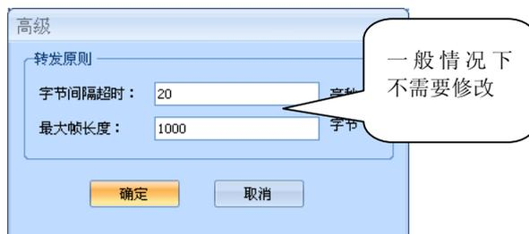
**字节间隔超时：** C2000 从串口收到字节后，在“字节间隔超时”过后，还没有从串
