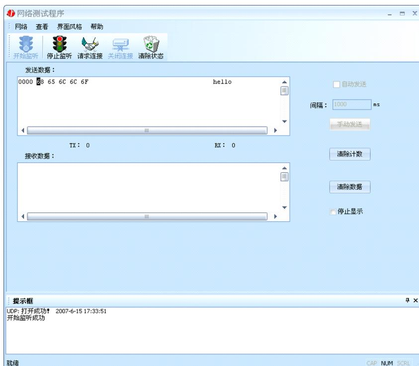
② 如果需要发送数据则需要建立连接。执行“请求连接”：弹出“对方 IP 及端口”
