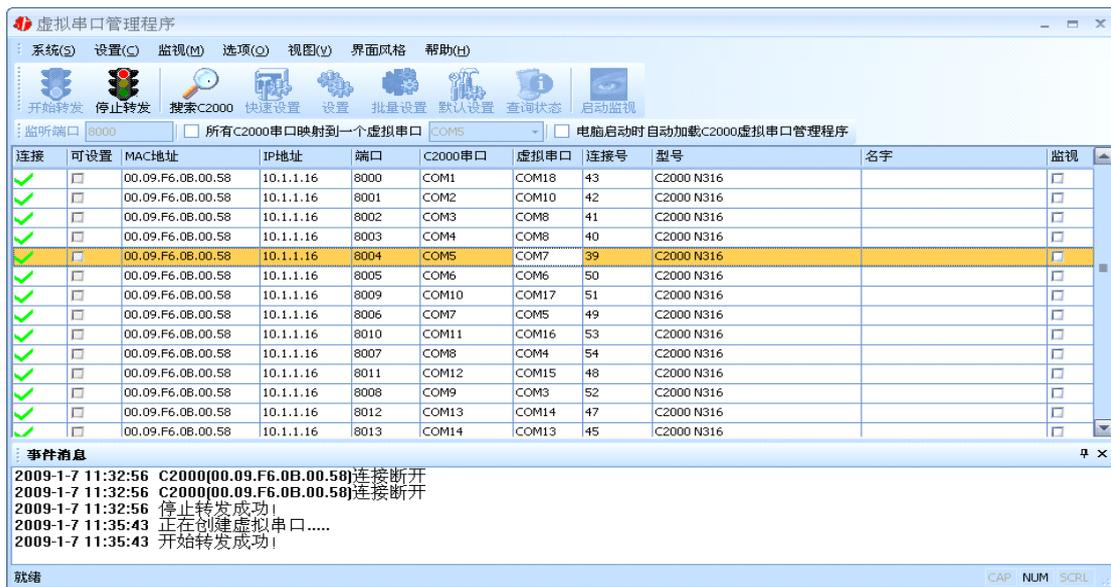
监听端口只有与服务器端口(在串口参数设置里面)匹配了才能正常转发正常, 否则会不能正常进行通信。虚拟串口已经创建完成, 开启用户软件, 选择相应的串口就可以进行通讯了。
