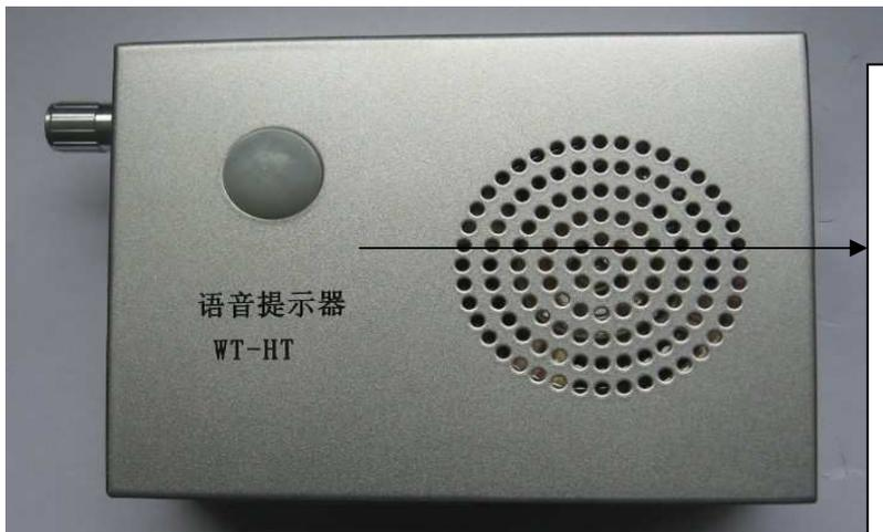
感应头，在开机后初始化时间 1.5-2.5 分钟，然后进入工作状态。每播报一次语音后，再有信号再开始播报，没有就进入休眠状态。感应广角是 120 度，在这个范围，如果有人进入，就会有感应信号发出。透镜不要被阳光直射或高温照射，否则影响感应信号。
