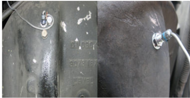
传感器在变速箱打眼安装位置
