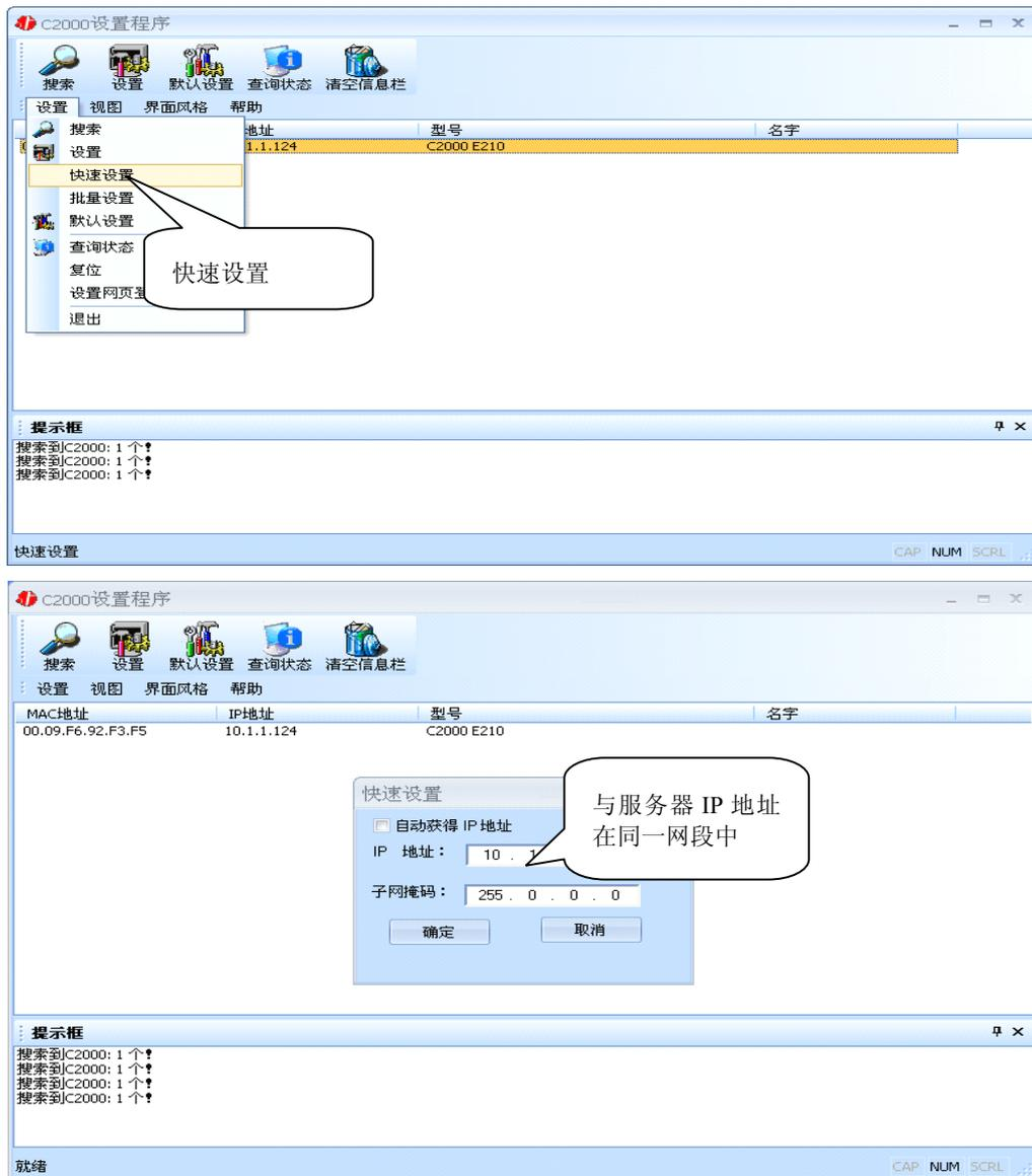
如果勾选“自动获得 IP 地址”，那么此 C2000 所在网段当中的 DHCP 服务器将为其自动分配 IP 地址；否则，需要人为指定 IP 地址。C2000 被默认设置为“**TCP Client**”方式，服务器 IP 默认为**本机 IP**，其他参数也均为**默认**，到此已经完成了设置。
