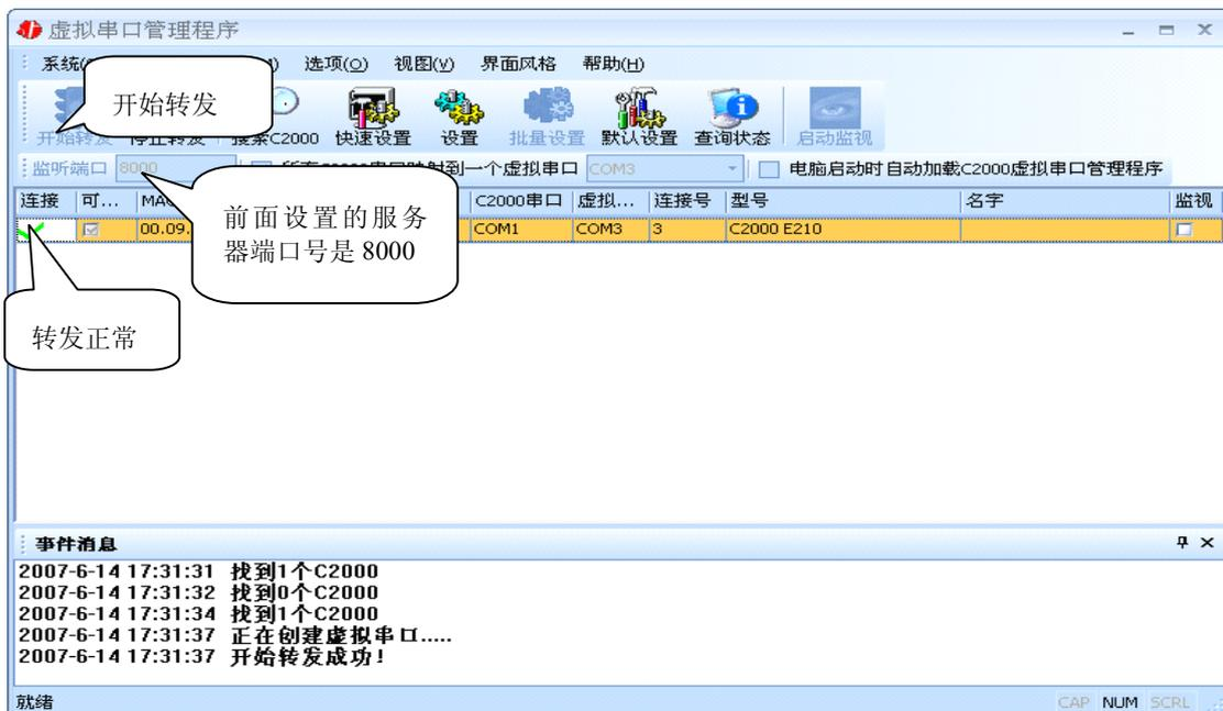
监听端口只有与服务器端口（在串口参数设置里面）匹配了才能正常转发，否则会
