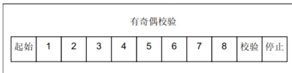
设备配置为奇校验、偶校验或无校验都可以接受。如果无奇偶校验，将传送一个附加的停止位以填充字符帧：
