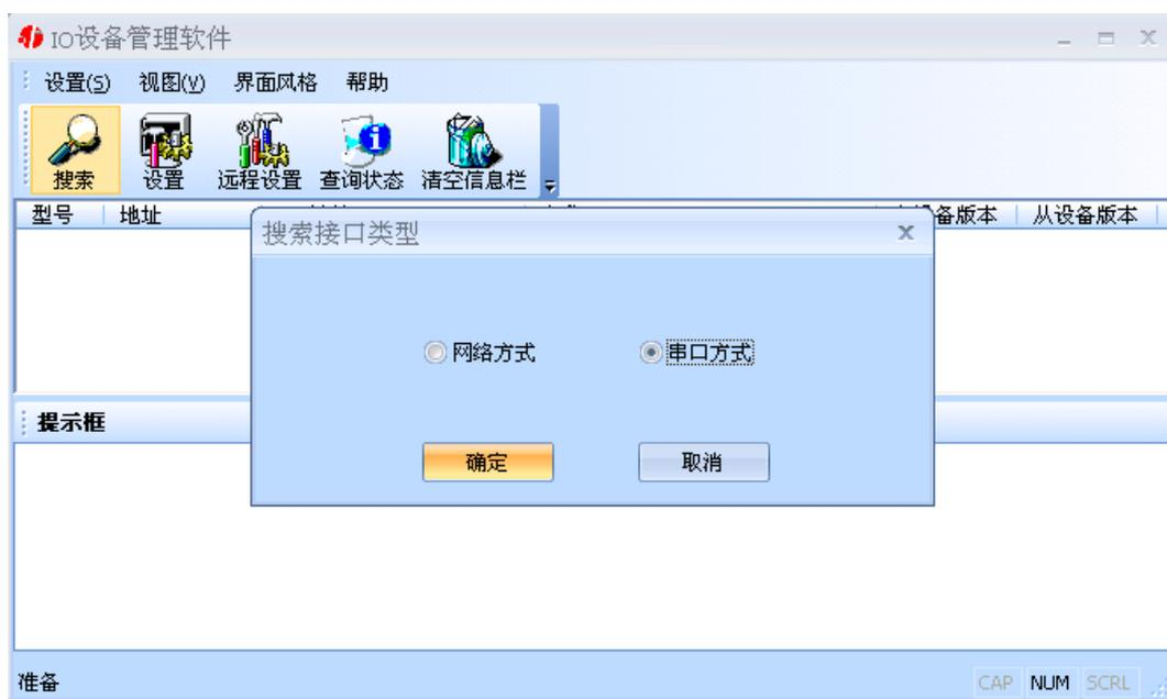
选择选择使用串口进行搜索，点击确定，弹出的提示框中选择我们连接IO设备的串口，并填入搜索的地址范围，在设置搜索范围时请根据实际情况进行设置，避免设置没有必要的大范围导致过长的时间占用。如下图：
