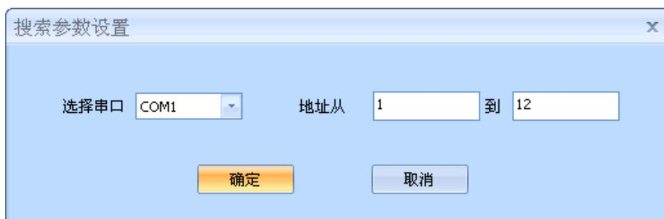
设置好搜索参数后，点击确定，开始搜索，会找到连接在我们串口的相应IO设备。
