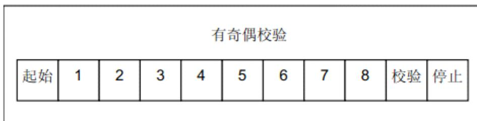
设备配置为奇校验、偶校验或无校验都可以接受。如果无奇偶校验，将传送一个附加的停止位以填充字符帧：
