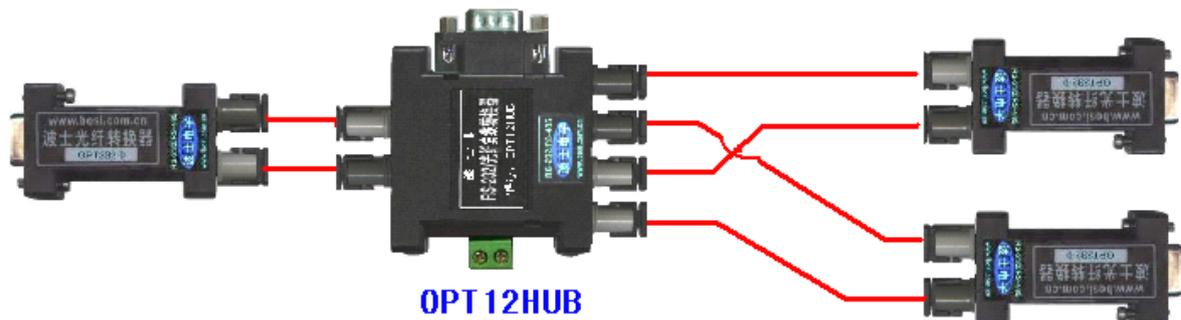
串口光纤星形组网的通信软件与总线型组网的软件是一样的。OPT12HUB 的 RS-232 也可以接一个节点。
