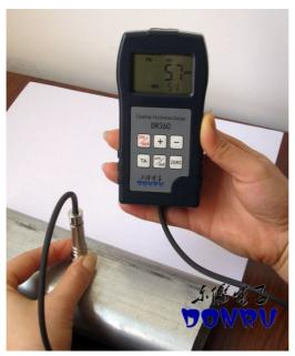
测量工件时,探头需要垂直快速压在被测量物体上,仪器自动连续进行测试
