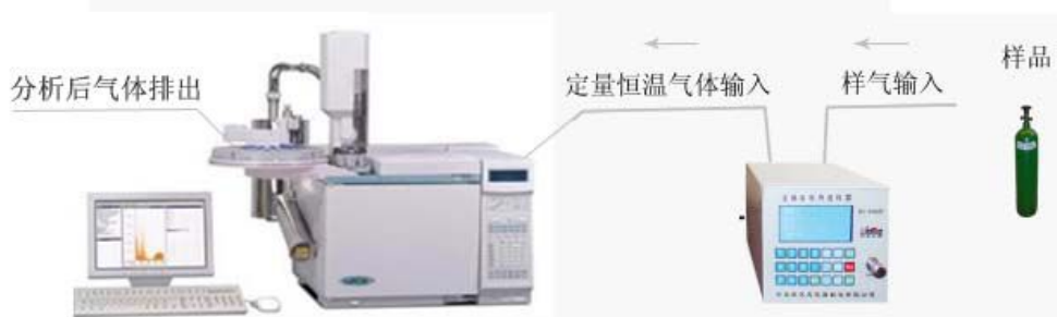
金属浴闪蒸进样器与露点仪、微量氧联机
