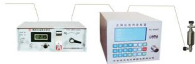
金属浴闪蒸进样器与露点仪、微量氧联机
