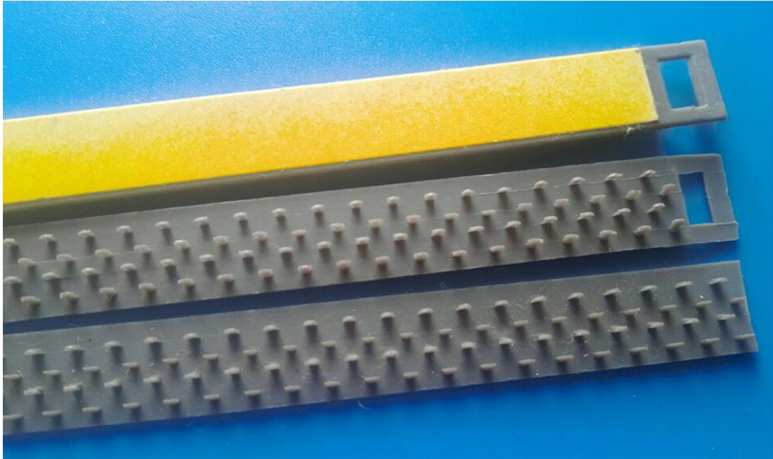
束网条为通讯机柜中的过滤网安装装置，公开了一种可用于各种通讯设备中过滤网安装的通用束网条；应用技术：159 ‘ ‘895 ‘ ‘94 ‘ ‘ ‘789’ ’ ’ 一种过滤网通用束网条，包括扁平状的连接条，连接条的一平面上设有多个沿连接条纵向交错分布的过滤网连接凸齿过滤网通用束网条，设置在连接条另一平面上的粘贴胶，过滤网连接凸齿是一种与连接条垂直固接的扁平状T型齿，安装过滤网时，不需要其他任何安装附件就能实现与过滤网的连接。
