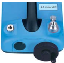
DPI 610/615LP微压校验仪 容积调节器 用于粗调 / 细调压力的 双活塞容积调节器 释放阀 通气和控制压力释放 压力接口 G1/8 (内螺纹) 2个 介质 非腐蚀性气体
