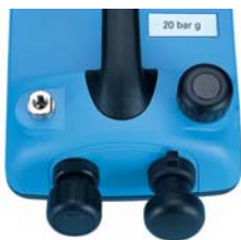
DPI 610/615PC气压校验仪 手泵 -85kPa ~ 2MPa 容积调节器 压力微调 释放阀 通气和控制压力释放 压力接口 G1/8 (内螺纹) 介质 一般气体
