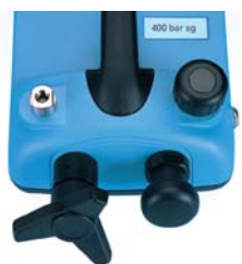
DPI 610/615HC液压校验仪 液压泵 M5 (内螺纹) 引液口 关闭阀 打开时系统引液 螺旋压轮 0 ~ 40MPa 压力接口 G1/8 (内螺纹) 介质 脱矿水或一般液压油
