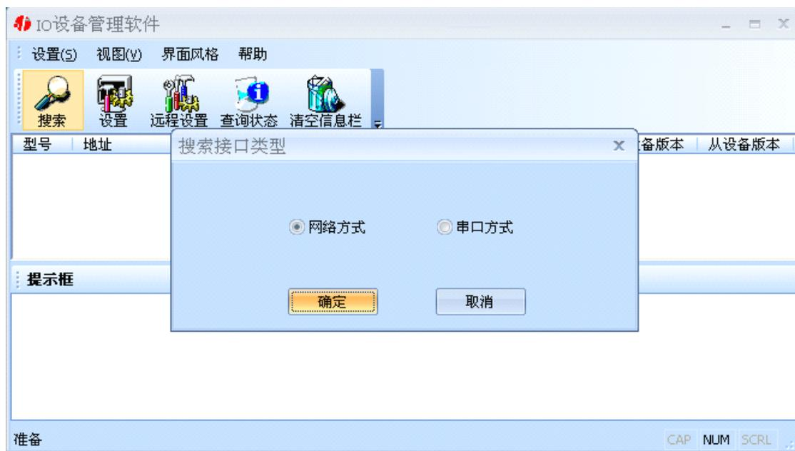
选择合适的通信方式，比如我们现在要用的网络方式。选择好相应的方式后，点击确定，设置程序就会找到我们连接本地局域网中的M244。如下图：
