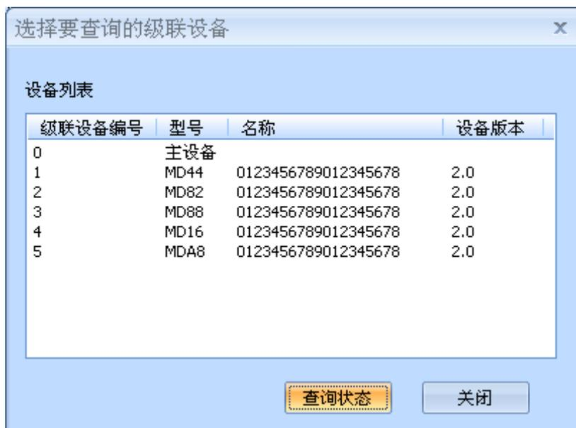
可以通过双击列表中的设备或选中列表中的设备点击“查询状态”按钮来对IO的状态进行查询。不管是主设备还是级联设备，都可以通过这种方式进行查询。
