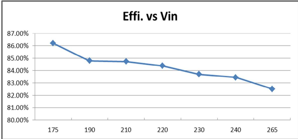
输入 175V~265V 电压范围内，输出平均效率：84.26%
