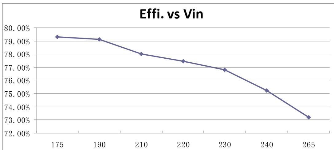
输入 175V~265V 电压范围内，输出平均效率：77.01%
