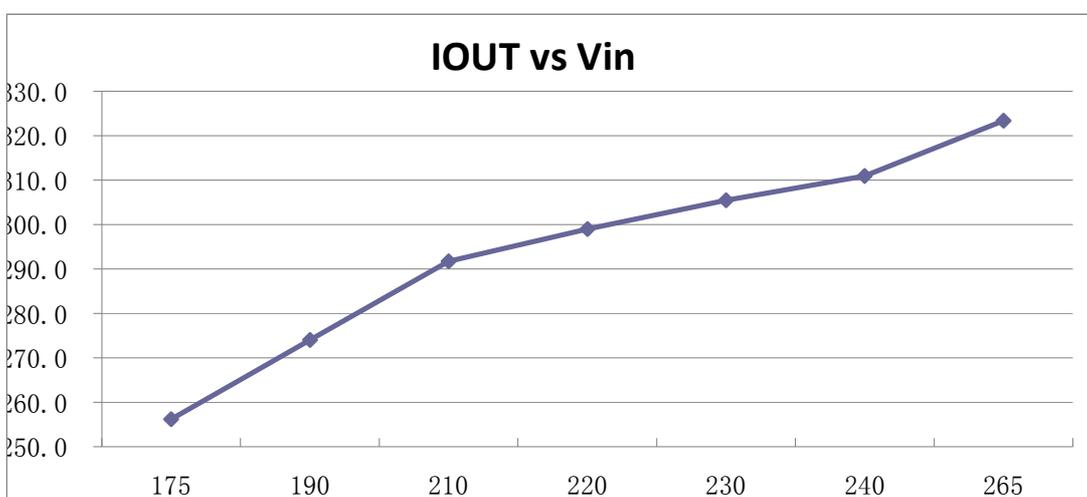
输入 175V~265V 电压范围内，输出恒流精度：±11.10%
