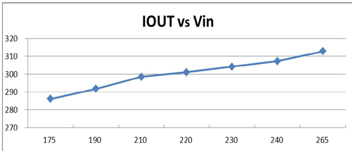
输入 175V~265V 电压范围内，输出恒流精度：±4.45%
