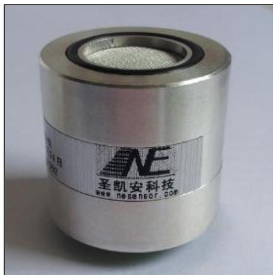
7NE 系列高精度红外气体传感器采用非色散红外(NDIR)检测技术,其外形尺寸小,具用设计的独特的结构特点,还可能按客户现场的要求设计,模块可以测检爆炸性气体和腐蚀性气体,传感器采用镀金引脚拔插结构,方便安装更换,可实现即插即用。可根据不同气体及量程对气路进行调整,气路采用气电隔离技术及防水防尘工
