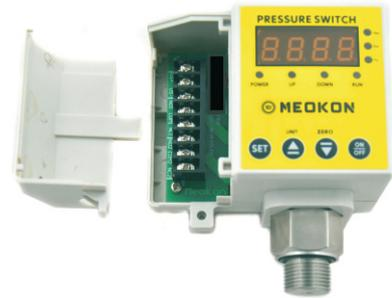
MD-S650 是一款智能型数显压力开关,集压力测量、显示、控制于一体的高精度数字式压力开关。它采用进口扩散硅隔离膜压力传感器作为敏感元件,测量精度高,长期稳定性好,介质兼容性强。
