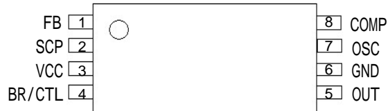
图1：引脚定义（顶视图）
