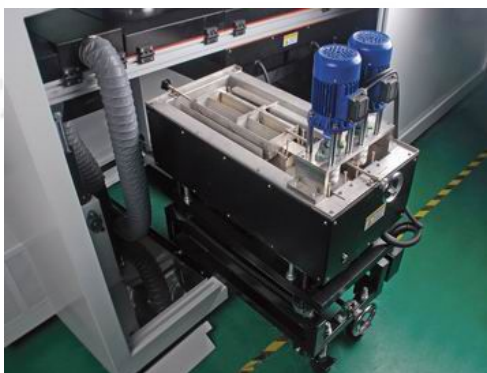
锡炉进出装置
