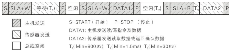
图 14: I 2 C 读写传感器完整示例图
