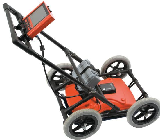
RD1000™是雷迪公司现有产品系列的补充。RD1000™使用现代雷达技术，可为用户实时显示出包含地下管线埋深和位置的剖面图像，是定位和开挖行业的理想工具。和传统的管线仪相比，RD1000™的优点是它可以直观探测各种管道，包括塑料管道。RD1000™使用防水材料，结构结实，可在任何地形环境中轻松使用。RD1000™只有一个包装箱，重量不到 23 公斤，只需两分钟就可安装使用，拆装容易，便于运输。模块式设计，维护、维修方便。RD1000™定位性能优越，强大的数字信息处理系统可实时、清楚地显示地下剖面图。数码颜色和数字增益控制最大限度地提高了定位质量，先进的数字滤波可滤除干扰信号，从而大大提高了定位准确度。RD1000™操作简单，LCD 显示屏配有直观的键盘和菜单系统，为操作人员提供各种应用功能。只需向后拉动雷达车，便可进行定位。定位模式下可抓拍到地下实时剖面图，光标显示底下管道的深度和位置。RD1000™采用单键式录制模式。图像存储在闪存卡上，同时闪存卡接口还可让用户进行固件升级。
