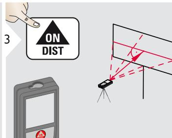
垂直对准该区域的水平中心线。该区域在垂直平面上必须非常水平。
