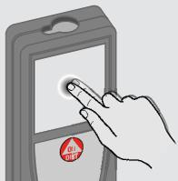
轻触显示屏以打开屏幕上的按钮或进行选择。轻触底线中间的图标以激活距离测量或启动摄像机。
