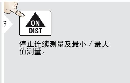
停止连续测量及最小 / 最大值测量。
