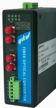
YFC 系列产品是易控达科技专门为 CAN 总线而设计的工业级光纤通讯中继产品。通过将该总线的电缆通讯转换为光纤通讯，实现了总线段间的信号光电隔离、完全隔离了总线段之间的电气干扰，同时具有总线信号再生、延长传输距离（与速率相关）、增加节点数以及改变组网拓扑结构的功能。支持基于 CAN2.0A/B 的各类总线如：CAN、DeviceNet、CANOpen、SDS、NMEA2000、SAE J1939、SAE J2284 等。
