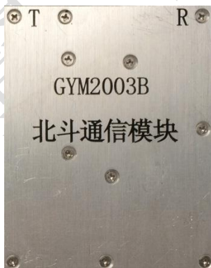
图 1 GYM2003B 北斗 RDSS 全功能通信模块示意图
