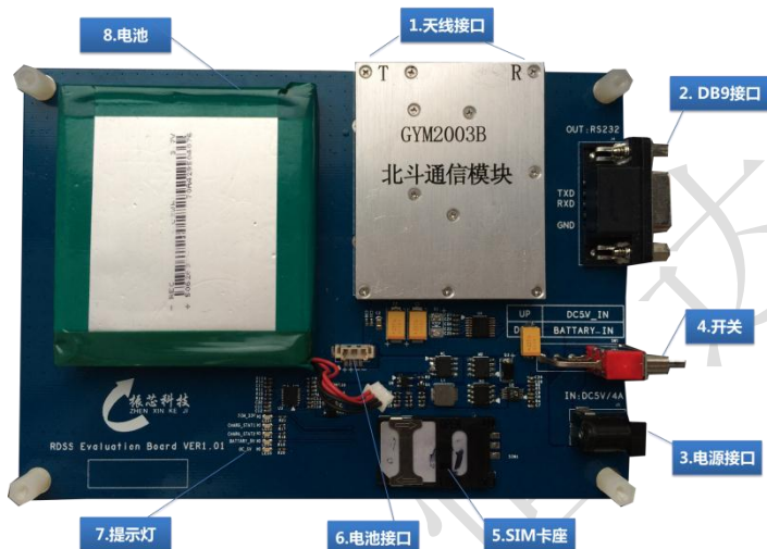
图 3 评估版外形构成示意图
